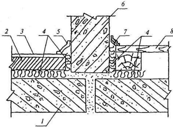
1 — несущая часть междуэтажного перекрытия; 2 — бетонное основание пола;
